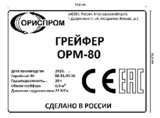
маркировка грейфера с 08.51.00.0001 по ... серийный номер вариант исполнения тип лепестков корпус
